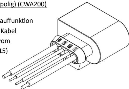
**Achtung:** Bei PIN 1 und PIN 4 handelt es sich um die Hauptstromleitungen der Wasserpumpe. Nutzen Sie hier ausschließlich Kabel mit passendem Querschnitt!
