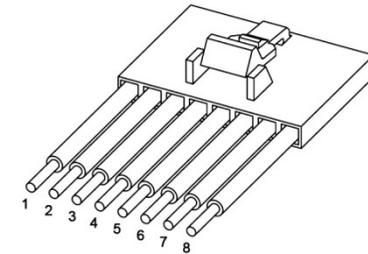
**Achtung:** Leitung 6 Lüfterrelais max. 0,4A bzw. min. 37Ω Spulenwiderstand
