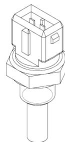
Bei dem Temperatursensor handelt es sich um einen handelsüblichen zweipoligen NTC mit einem M12x1,5 Gewinde und einem Dichtring aus Kupfer.
